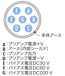
図2 プリアンプコネクタ(例)
